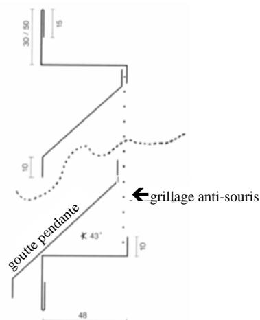
En tôle d'acier zingué sendzimir recouvrement 30mm (P.V. pour recouvrement 50mm = 15%)
